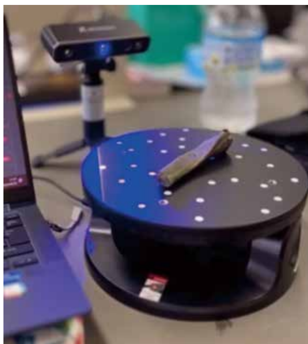
Fig. 3. Revopoint MINI による瑞浪釜戸標本スキャンの様子.
